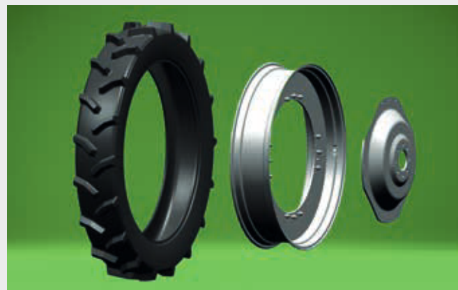
↑ Pneus estreitos para utilização em plantio em linha.
