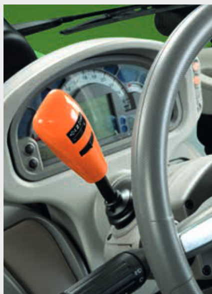
↑ Inversor eletro-hidráulico (Powershuttle) com reatividade ajustável.
