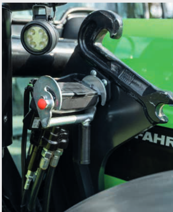
↑ Estrutura fixa do carregador frontal com ligação Hydro-Fix.
