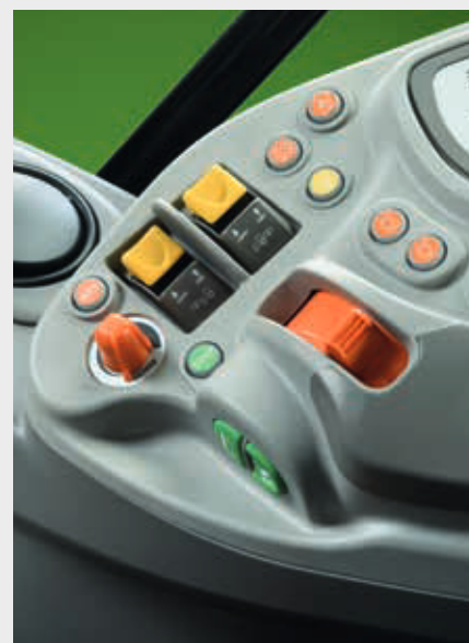
↑ TDF traseira e dianteira com engate eletro-hidráulico e função TDF AUTO.
