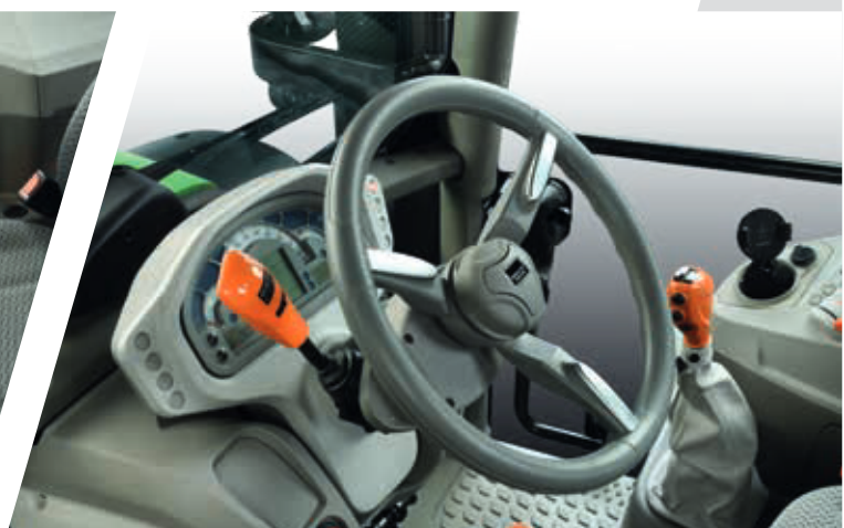
> PowerShuttle com 5 níveis de regulação SenseClutch e função Stop&Go.
