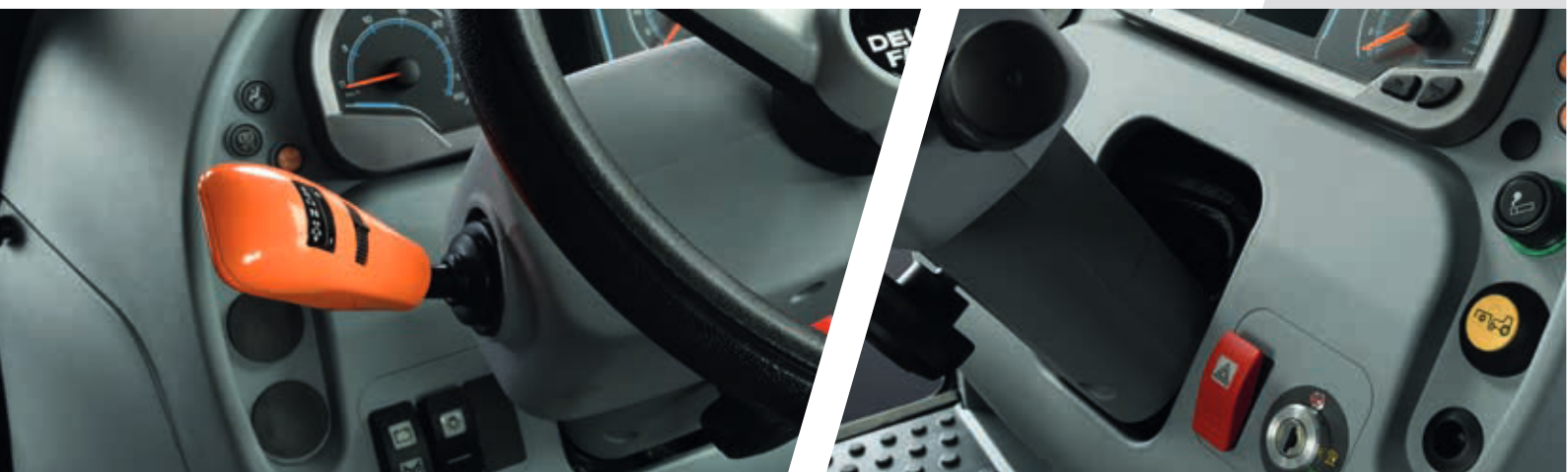
> Inversor eletro-hidráulico (PowerShuttle) com SenseClutch (5 níveis ajustáveis).
